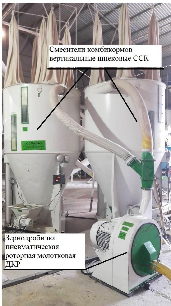
Рисунок 19. Технологическое оборудование, используемое при процессах дробления зерна
