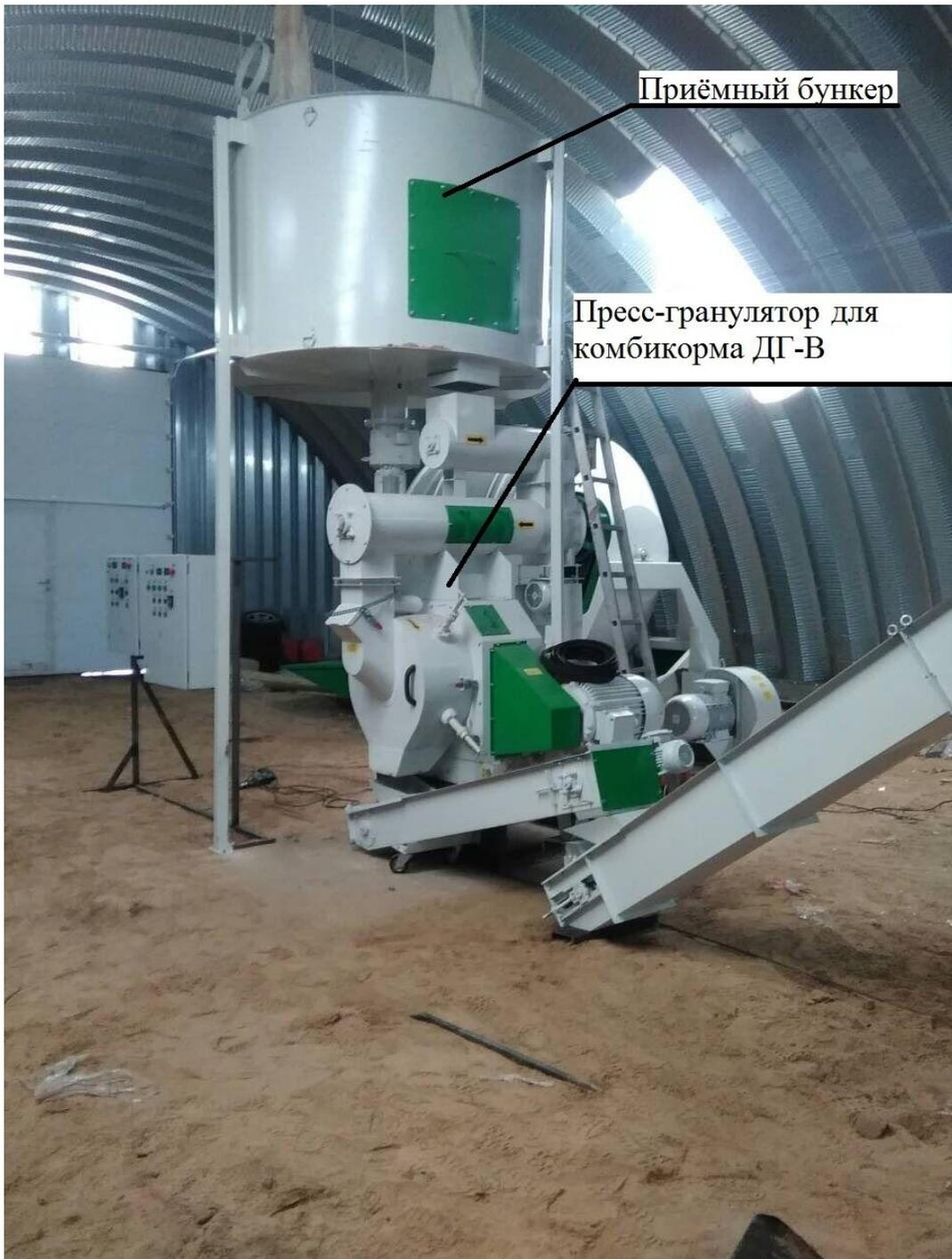
Рисунок 21. Технологическое оборудование, используемое при процессах формирования гранул и дозировании
